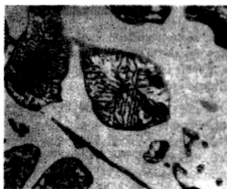
FIGURA 4-14 Los átomos cerca de las fronteras de los tres granos no tienen un espaciamento o arreglo de equilibrio.
