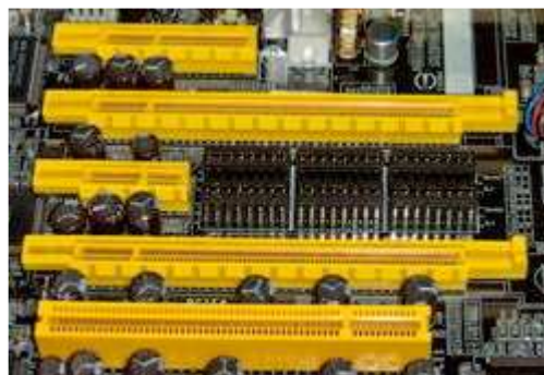
Slots PCI Express (de arriba a abajo: x4, x16, x1 y x16), comparado con uno tradicional PCI de 32 bits, tal como se ven en la placa .
